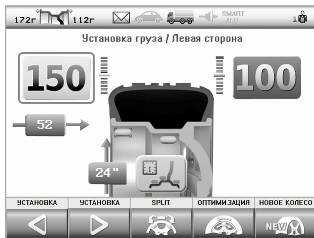
б – установить ленточный груз 150 г слева в положение «6 час»
